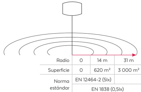
Como entender el dibujo: en un rango de 31 m, siendo una superficie de 3 000 m<sup>2</sup>, garantizamos una iluminación conforme a la norma EN1838.
